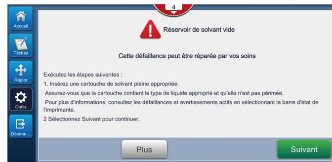
Figure 5 : Défaillance de réservoir de solvant vide (E15062)
