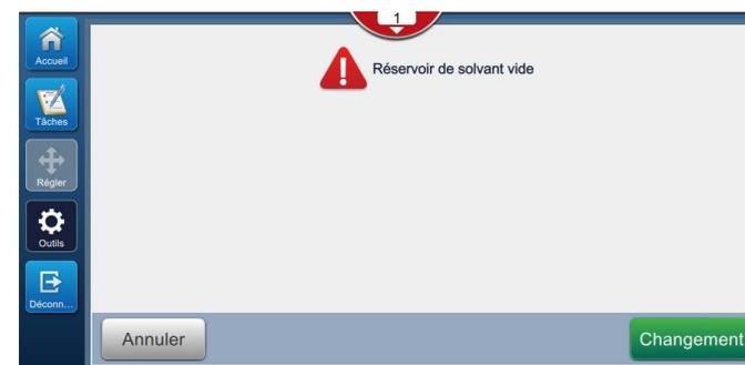
Figure 6 : Défaillance de réservoir de solvant vide (E15062)
